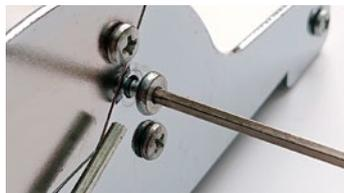
Dann auf beiden Seiten die Imbusschrauben herausdrehen und den Deckel öffnen.
