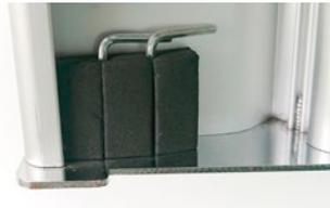
An der Unterseite des Displays stecken zwei Imbusschlüssel.
