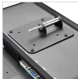
Die Adapterplatte wird am Monitor befestigt
